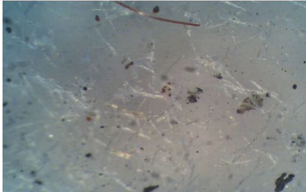
Նկ. 2. Աղաթթվով մշակված թերայրուկի քլորացման եռակալվածքի աղաթթվով տարրալուծման լուծույթից վերականգնված ազնիվ մետաղական արգասիքի մանրակառուցվածքը
